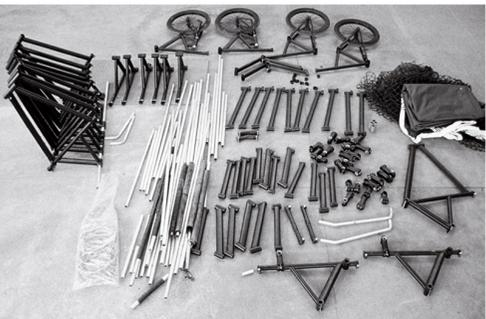
Pièces d'assemblage disposées au sol. Ces éléments suffisent à la construction des chariots, radeaux, traîneaux et autres mobiliers.
