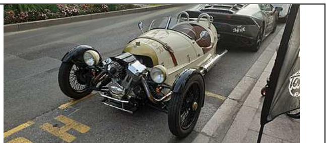
Morgan 3-wheeler - idée à reprendre : moteur bicylindre en V pour le moteur thermique
