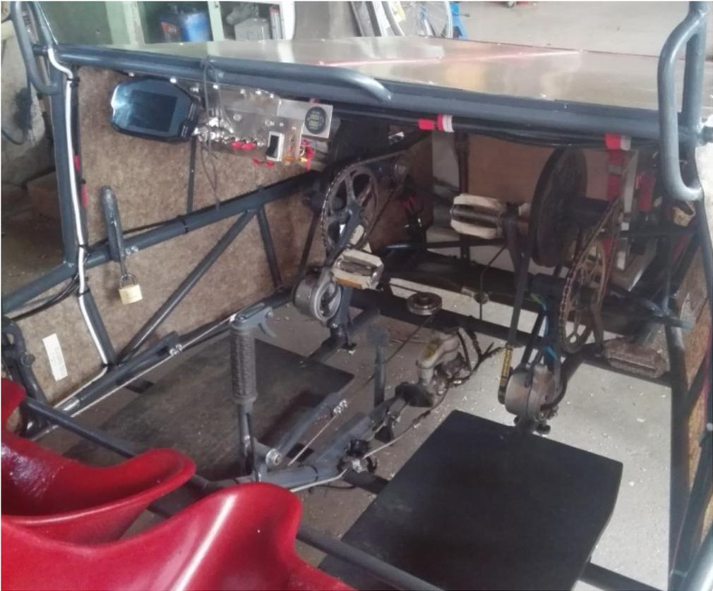
Concernant le choix des matériaux, la structure est réalisée en tubes d'acier entièrement recyclable, la couverture en plaques de Kairlin (plaques de fibres de lin structurées par une résine végétale) entièrement recyclable. Les pédales, les roues, disques et freins avant sont de réemploi.
