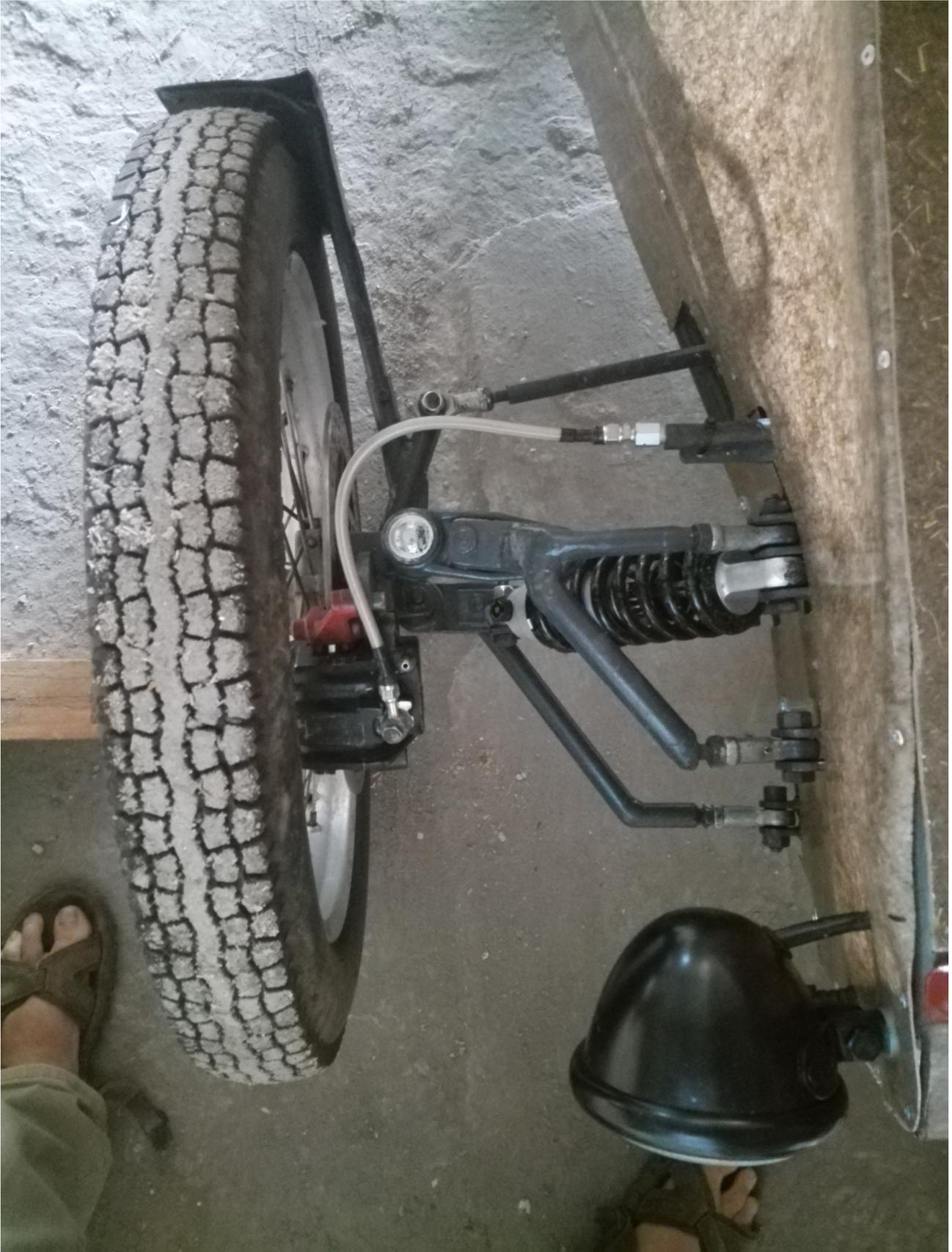
AR : mono bras oscillant, ressort et amortisseur hydraulique
