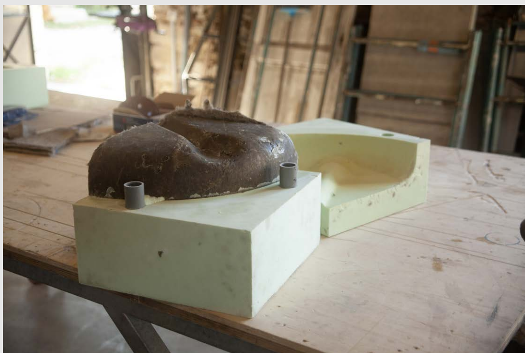
Démoulage du garde-boue avant
