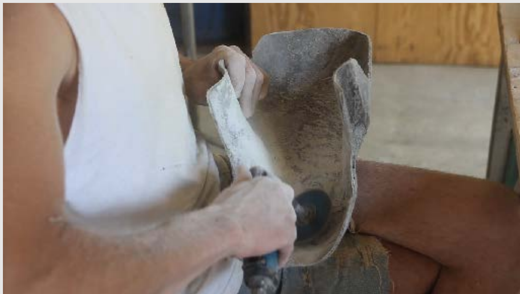
Découpe et finition du garde-boue avant
