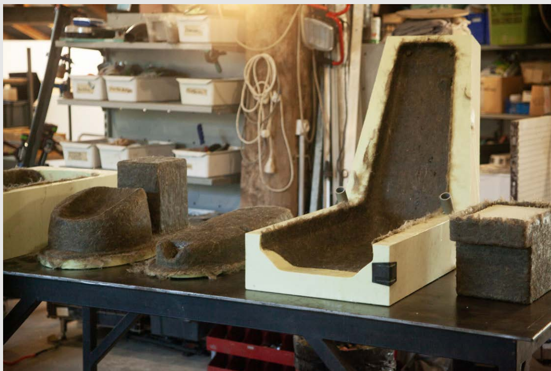
Pièces laminées en phase de polymérisation
