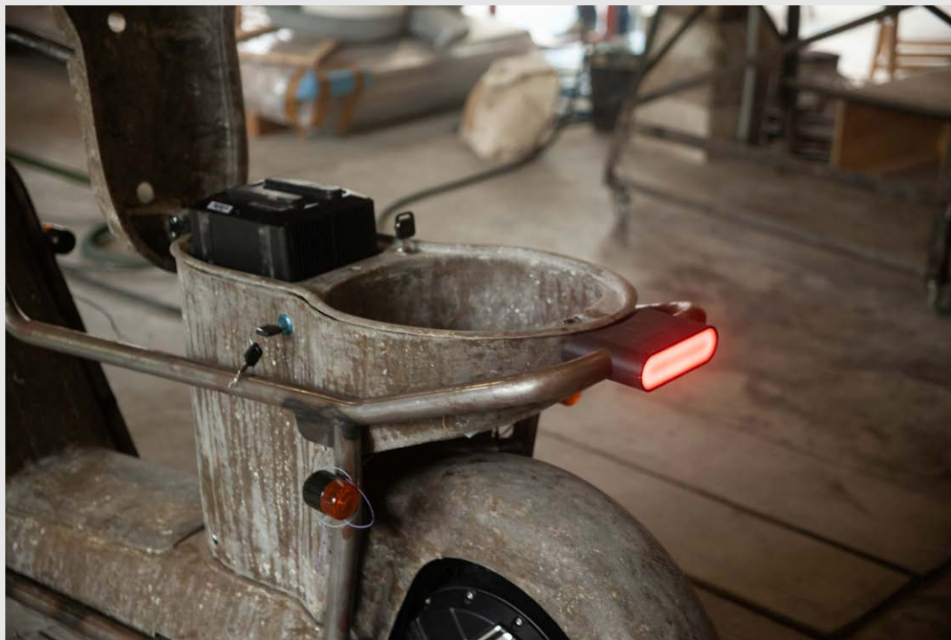
Vue du coffre de selle comprenant l'emplacement de la batterie et d'un casque
