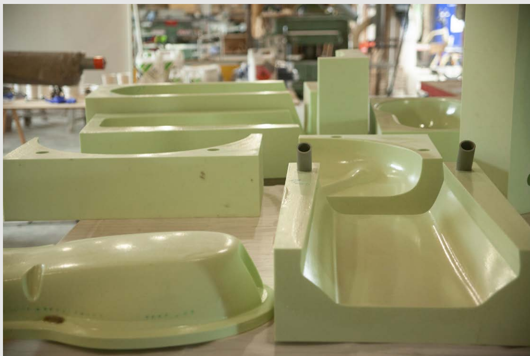
Moules finis à l'issue des étapes de ponçage, résinage puis cirage.
