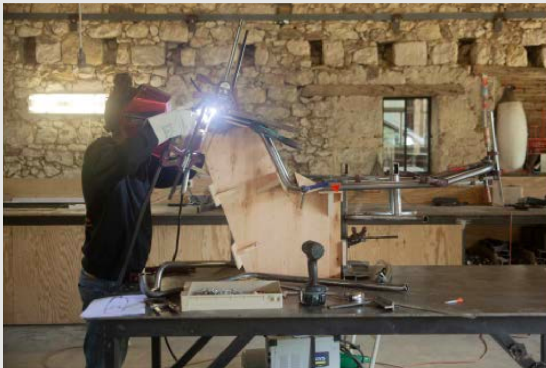
Soudure du tube de fourche
