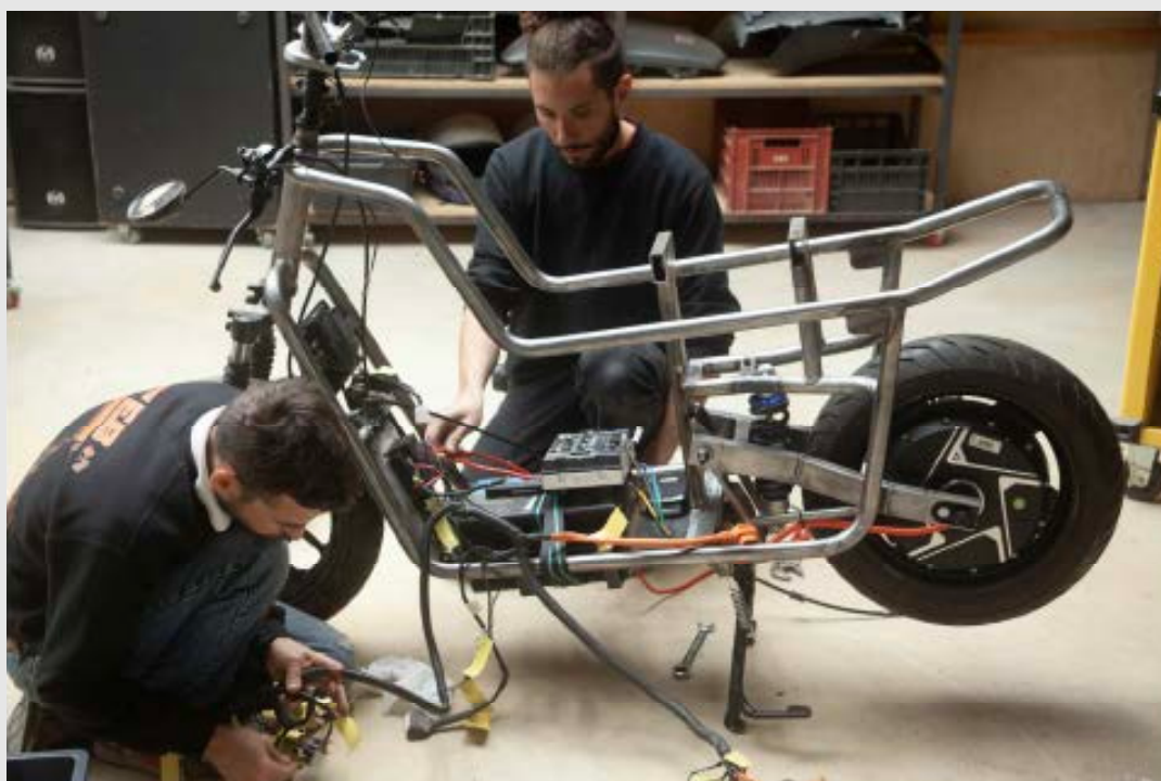
Organisation (temporaire) du faisceau de câbles
