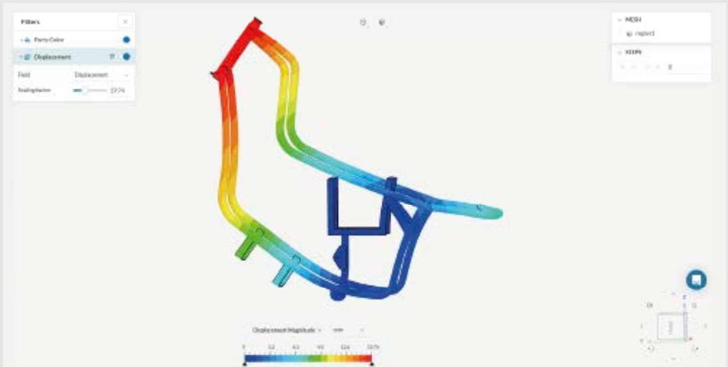
Déformation attendue pour une charge de 1000kg amplifiée d'un facteur 30 (1,5cm max)
