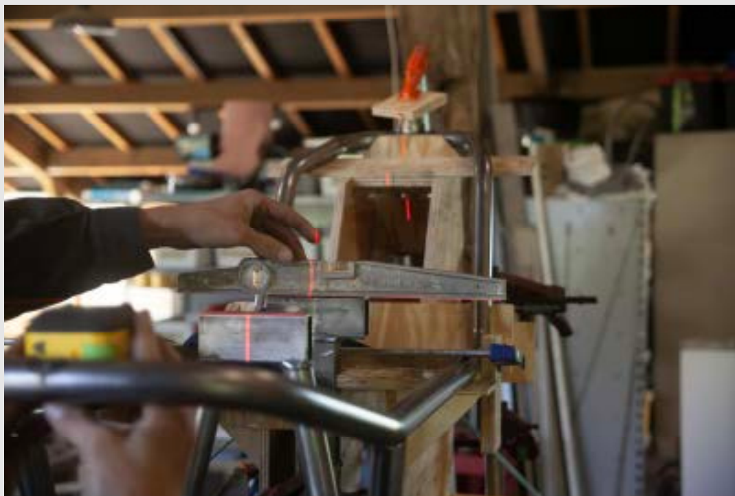
Alignement au laser des éléments du châssis
