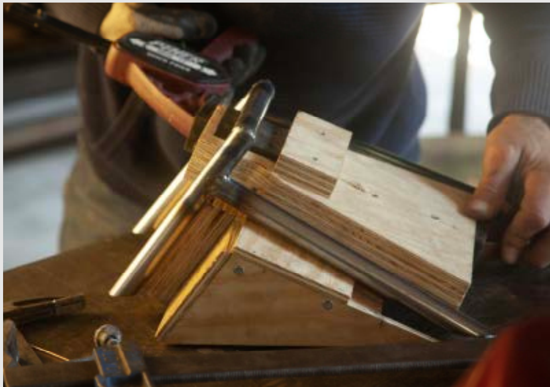
Pièce de renfort du bras oscillant ajustée à son gabarit
