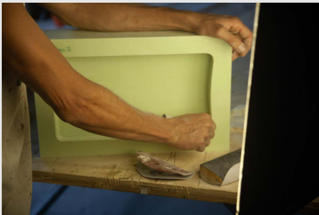
Ponçage, résinage, ponçage
