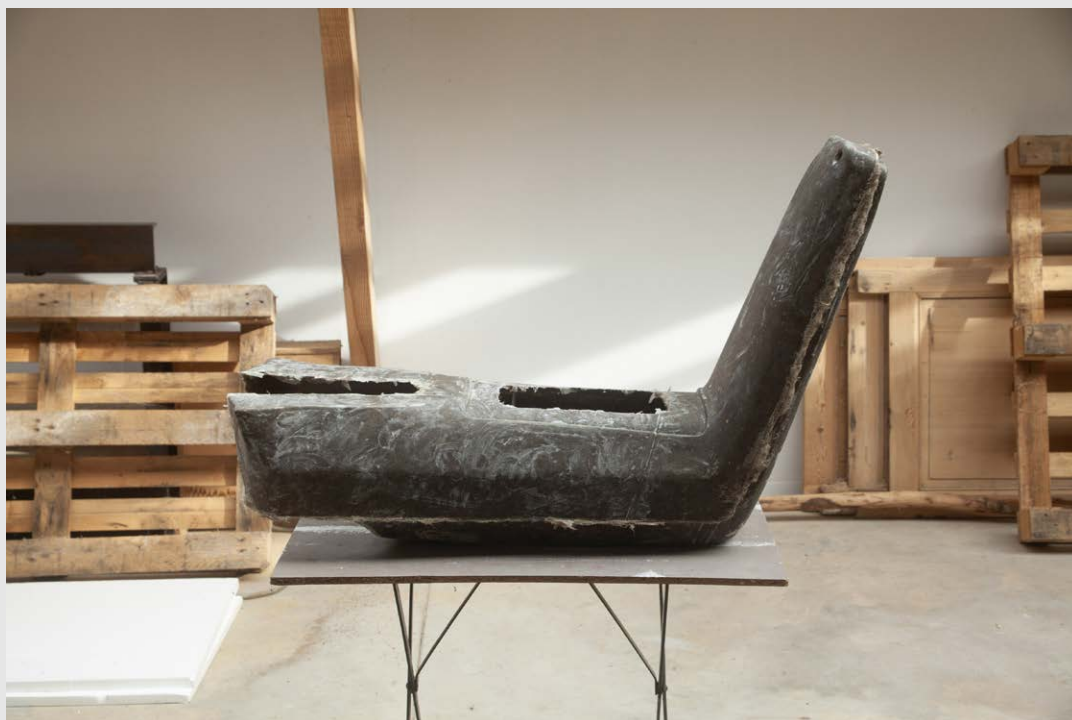
Plancher et carénage bas en sortie de moule
