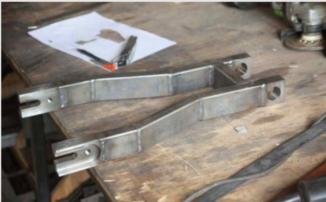
Bras oscillant en profilé acier rectangle et extrémités usinées rapportées.
