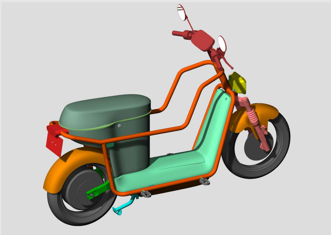
17. Installation du phare avant et des cales pieds
