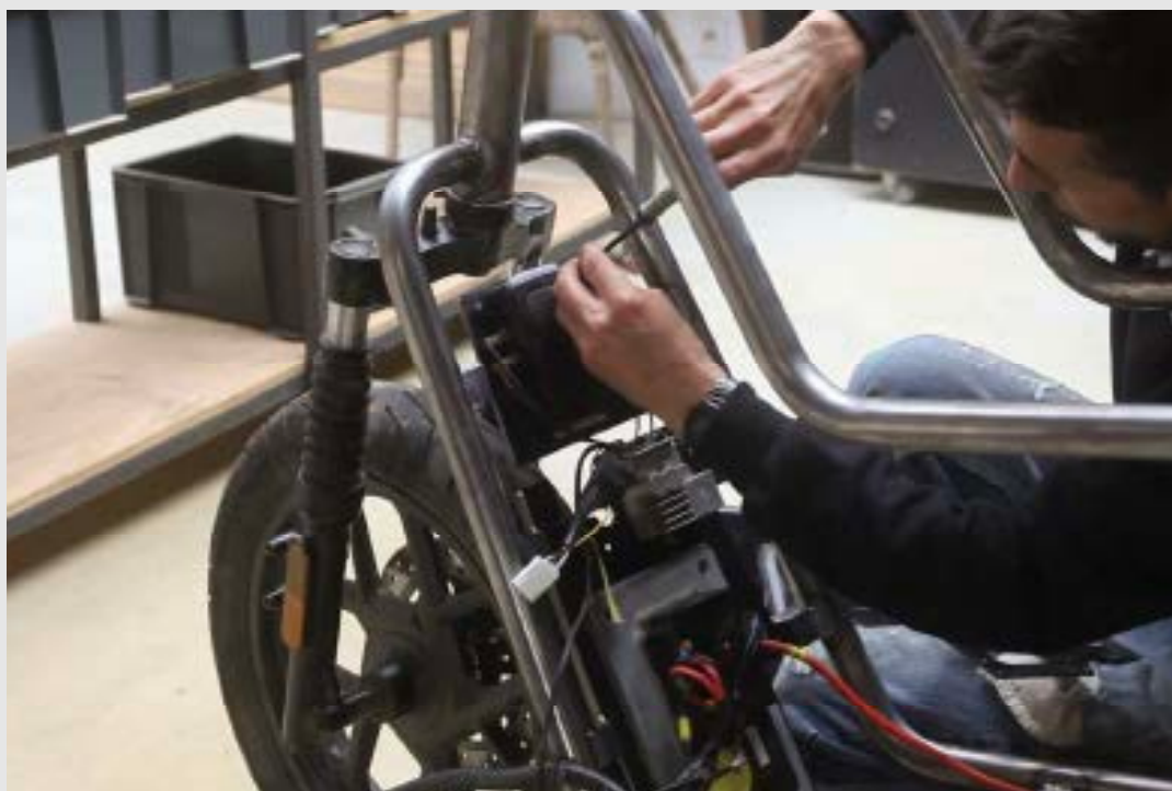
Fixation des composants électronique aux supports en tôle du tablier
