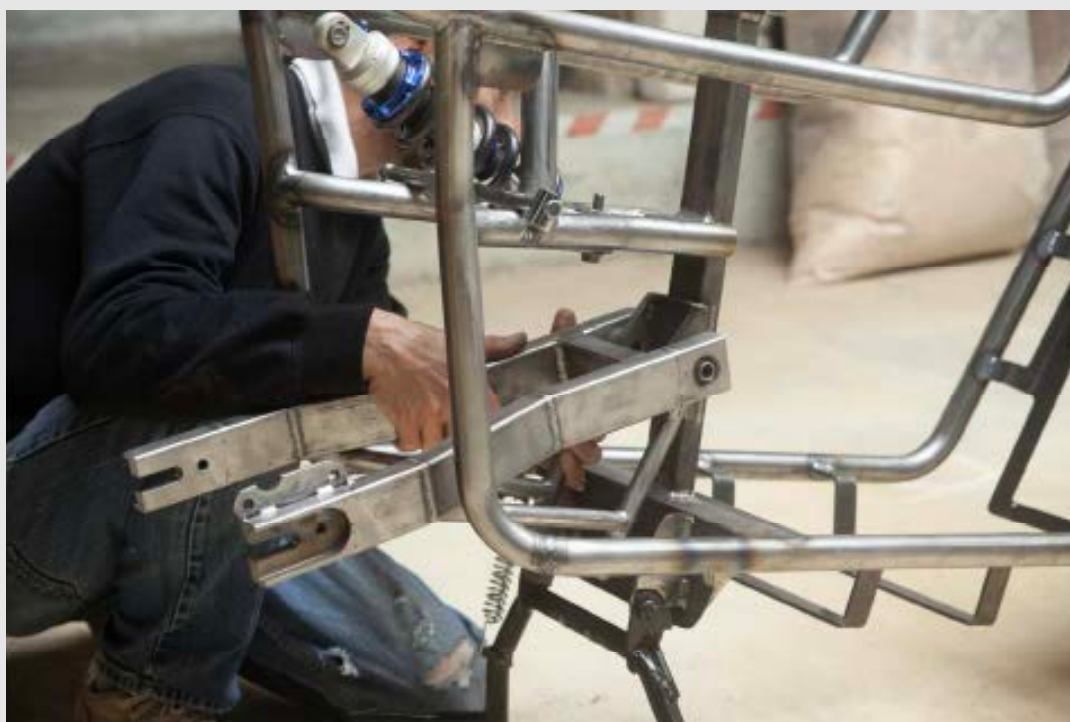
Montage du bras oscillant
