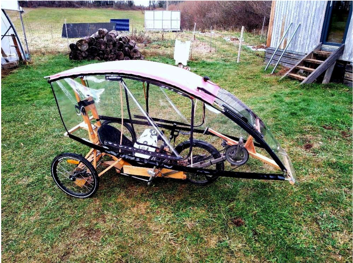
Le moskitOS v4 équipé de sa protection complète développée durant cette saison
